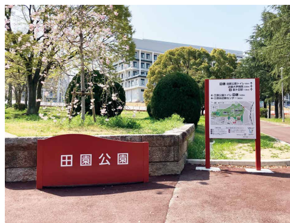
記名サイン 表示板サイズ：W1500xH750 表示方法：カッティングシート 本体素材：アルミ押出形材
